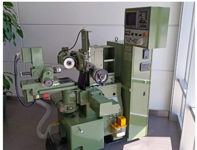
図3 1985年に発売が開始された高精度 CNC 工具研削盤 CNJ-10
