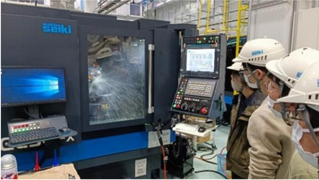
図4 砥石・研削液ノズル交換装置を備えた高精度 CNC 工具研削盤 AGE30FX
