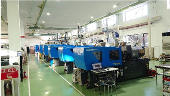
図3. テクノロジーセンターの様々な種類の射出成形機
