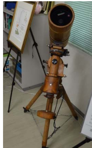
図2 三鷹製望遠鏡と同じ設計で製作した木造望遠鏡
