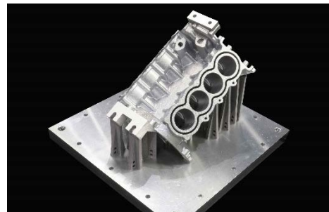
写真7 金属光造形によるエンジブロック
