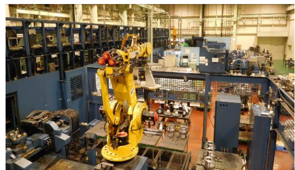
写真4 大型パレットと搬送ロボットを用いたロボットライン
