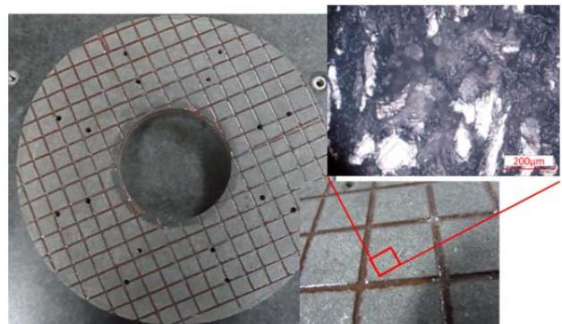
図3 ステンレス短繊維含有ラッピング定盤
