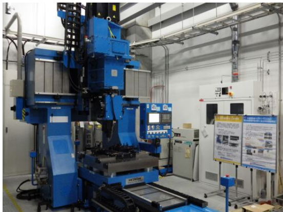
図 5 摩擦攪拌接合装置
