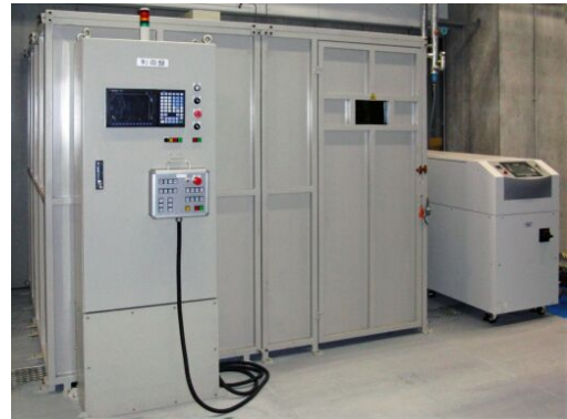
図 6 パルス YAG レーザ溶接装置
