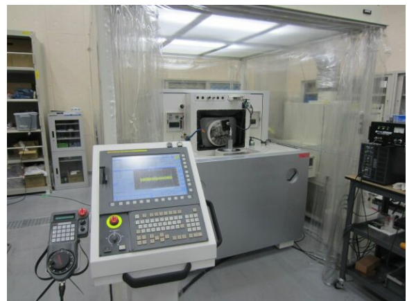
図3 超精密微細加工機(Fanuc Robonano α-0iB)
