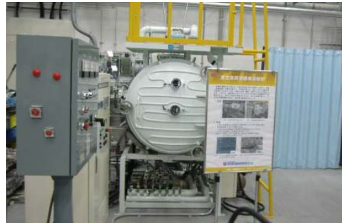
図 7 真空高周波誘導溶解炉
