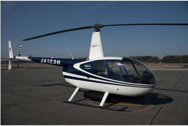
図3. 航空レーザ計測、および、空中写真に用いられるヘリコプタ。測位システム等の設備が搭載されている。
