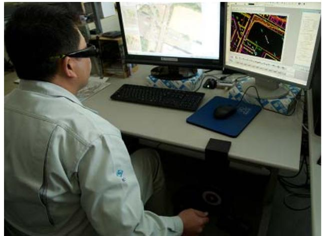
図5. 写真測量用のマシンを活用し、建物等の地物形状を描画して基図を更新している様子。
