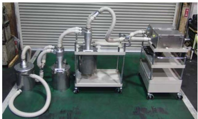
写真3 サポート・インダストリーにて開発した CFRP 集塵装置
