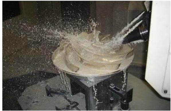
写真6 5軸マシニングセンタによるエンジン部品の複雑形状加工
