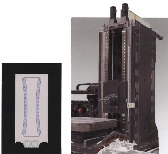
図4 「つづみ型」コラムガイドウェイ （左）外略図，（右）写真
