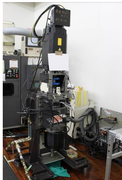
図2 スピンドルの全数検査
