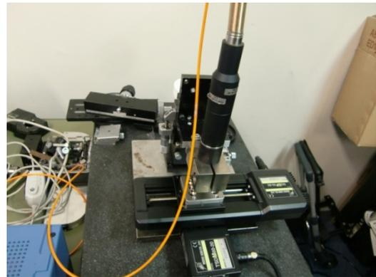
写真6. 非接触三次元表面形状測定装置
