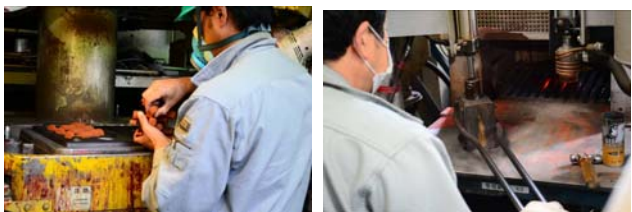
写真4 (左) 主型に中子を入れる工程 (右) 中子の製造工程
