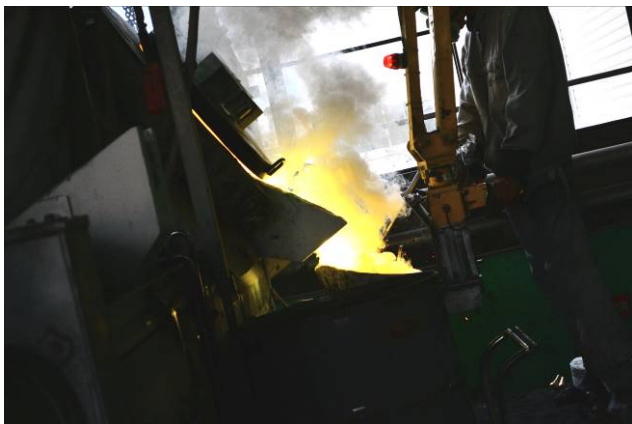
写真3 炉からとりべ取鍋に銅合金を流し込む作業
