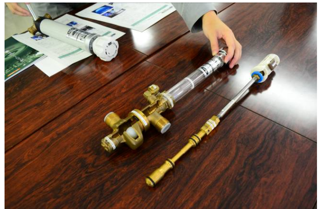
写真2 不凍給水栓のカット見本
