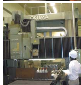
写真4(左上) ショールームでNCロータリーテーブルについて説明される大森工機技術部長／写真5(上) 工場内には透明なカーテンで仕切られた恒温室ならぬ恒温ブース(三次元測定器用)も所々に設けられていた／写真6(左下) 大型円テーブルの切削加工のために用いられる大型の門型フライス盤。直前に立たせていただいたが(写真右下が千保)、その大きさに唖然とした。
