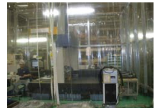
写真4(左上) ショールームでNCロータリーテーブルについて説明される大森工機技術部長／写真5(上) 工場内には透明なカーテンで仕切られた恒温室ならぬ恒温ブース(三次元測定器用)も所々に設けられていた／写真6(左下) 大型円テーブルの切削加工のために用いられる大型の門型フライス盤。直前に立たせていただいたが(写真右下が千保)、その大きさに唖然とした。
