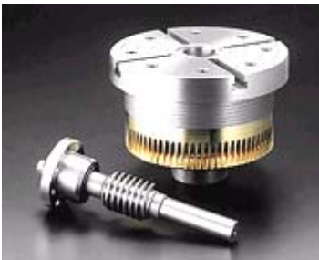
写真8(左)ウォームギヤとホイールの外観/写真9(下)複リードギヤシステムの模式図。ウォームの歯厚が図中左に向かって厚くなっている。これにより、理想的な噛み合いを維持したままバックラッシを調整できる。
