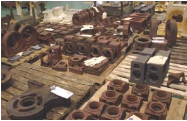
写真7(左)工場内には様々な形状の鋳造部材が並ぶ。これらは鋳造品部門である松任工場から送られてくる。松任工場では1200t/月の生産能力を有する。
