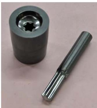
写真5 特殊星ネジ用2ピースパンチ 隅部の応力集中を避け、破損時のピン交換を可能とする構造を有する。ピン側面のスライドは交差 $2\mu\text{m}$ の仕上げ加工が行われており、自由にスライドさせることが可能
