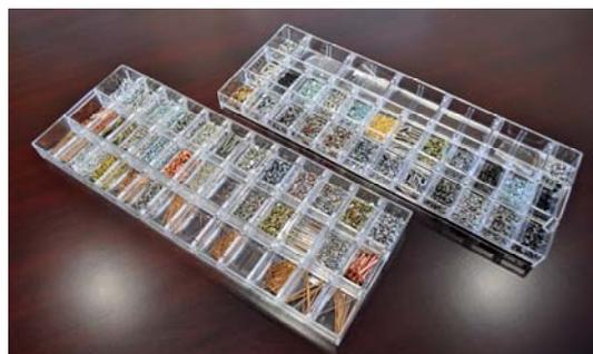
写真3 微細ネジの例。IT製品等で使用される径1mm以下のネジはほぼオーダーに合わせた受注生産となるため、それぞれ独自のヘッダーが必要とされる
