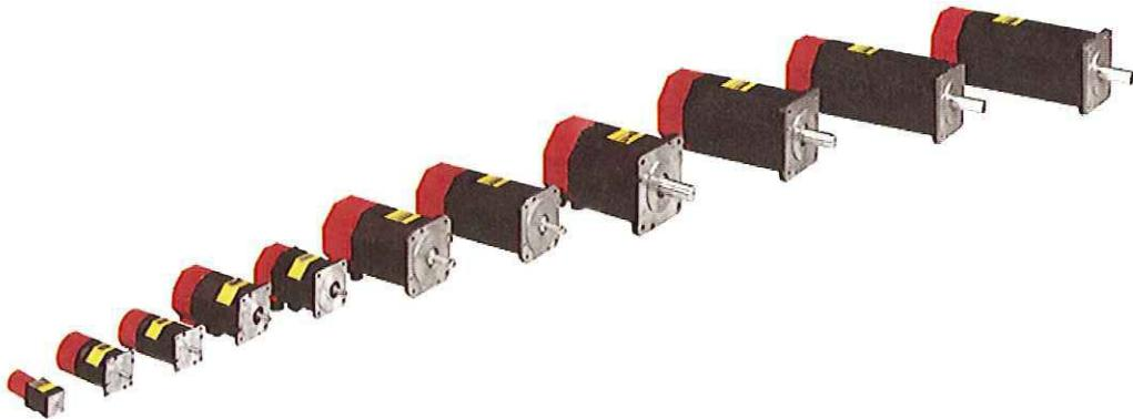
昭和57年（1982年）には、工作機械の高速化のため、DCサーボモータに変えてACサーボモータを開発しました。DCサーボモータは、重切削時のロータ巻線温度上昇が大きいこと、整流用ブラシからの火花により最高回転数が制限されることが問題でした。パワー半導体の進歩、高性能希土類磁石の出現もACサーボモータへの転換を容易にしました。
