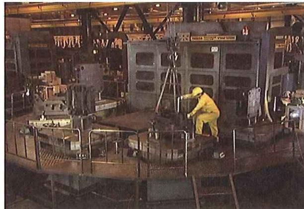
これは、昭和 55 年（1980 年）に導入した第一世代機械加工システムの一例です。作業者が、ワークを搭載した加工治具をパレットマガジン装置に取り付けています。24 時間の連続無人運転を実現しました。
