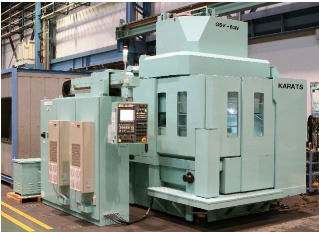
写真3 ギヤスカイピングマシン GSV-60N
