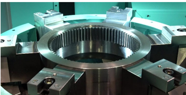
写真4 GSV-60Nにより加工された内歯車
