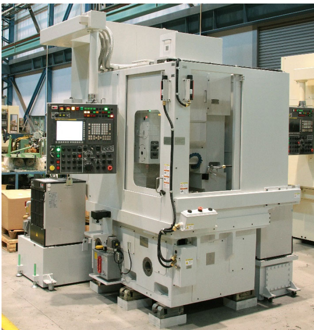
写真5 歯車形削り盤 GSM-12N
