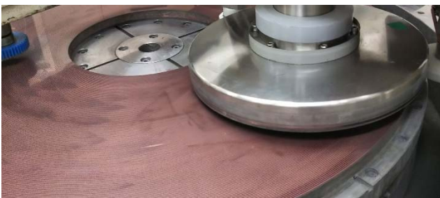
図6 溝がある銅の定盤
