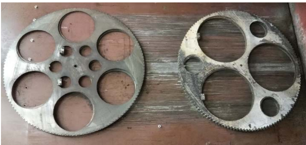
図5 キャリヤ（加工物を装着する穴の開いたギヤ）
