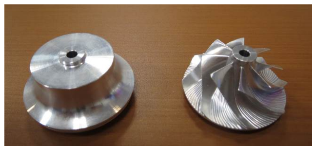
写真2 加工前（左）と加工後（右）のインペラ。この複雑な形状を短時間で加工する事に驚愕。
