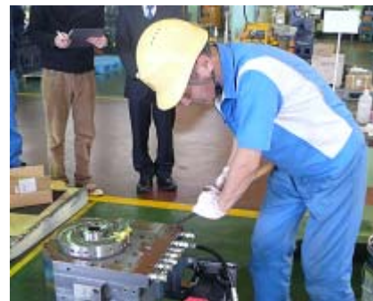
写真3 きさげ加工 体全体を使う精密手仕上げ作業である。
