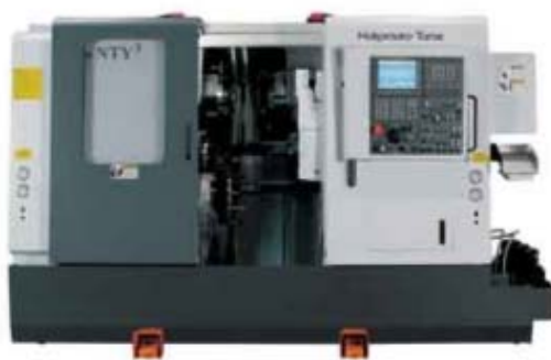
写真4 複合加工機 2つの対向主軸と3つのタレットが搭載されている
